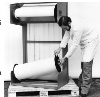
Dario Zucchelli alle prese con il primo brevetto Società Italiana Filtri: sistema rotativo a motorizzazione assiale, 1981
